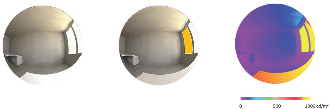
Abb. 1.3.9-2 Lichtstärkenverteilung im Innenraum (Quelle: Transsolar)
